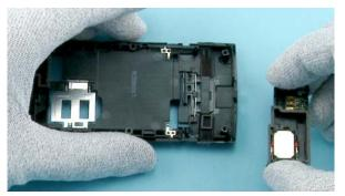
35) Remove the ANTENNA MODULE ASSY.
